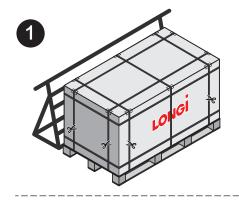
需要将待拆包的整托组件长边靠近坚实的支撑物:优先防倒支架、墙壁或者一托同规格且未拆组件(距离约为15~20cm),然后用工具剪断外包装全部打包带。
